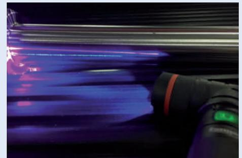
Feine Risse werden mit UV-Licht und fluoreszierendem Prüfmittel sichtbar gemacht.
